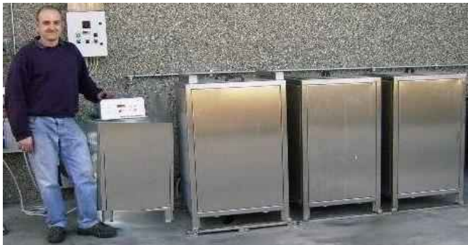
Applicazione di lavaggio ultrasuoni, risciacquo, protezione dewatering e asciugatura automatica nella meccanica industriale
